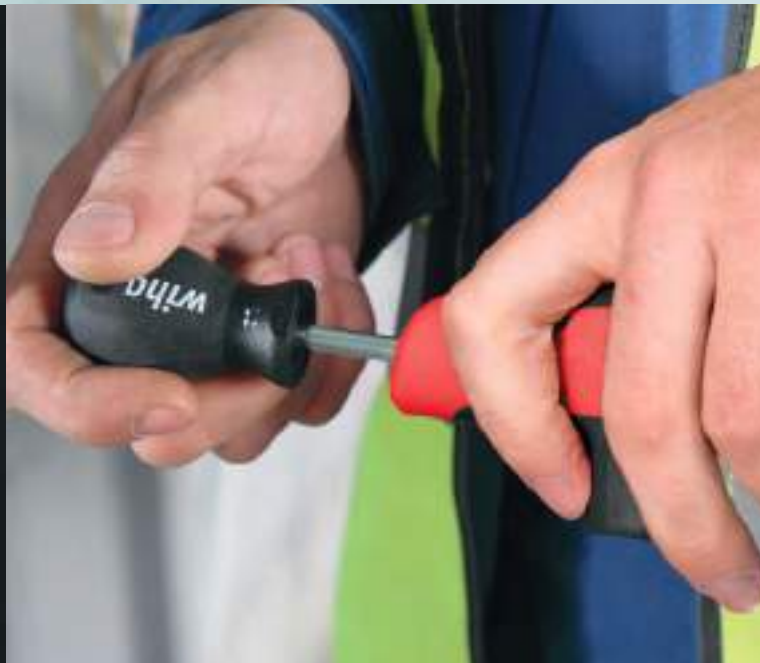
Coppia meccanica a regolazione variabile
