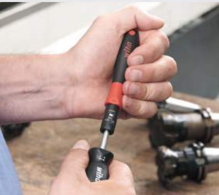
Coppia meccanica a regolazione variabile
