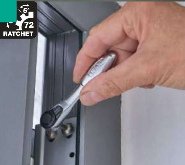
Mini-cricchetto a dentatura fine con rotazione oraria/antioraria
