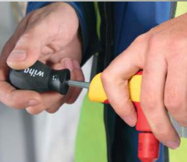
Coppia meccanica a regolazione variabile
