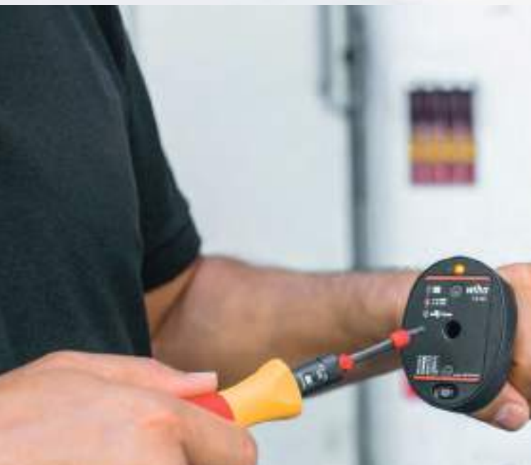
Controllo mobile di chiavi dinamometriche
